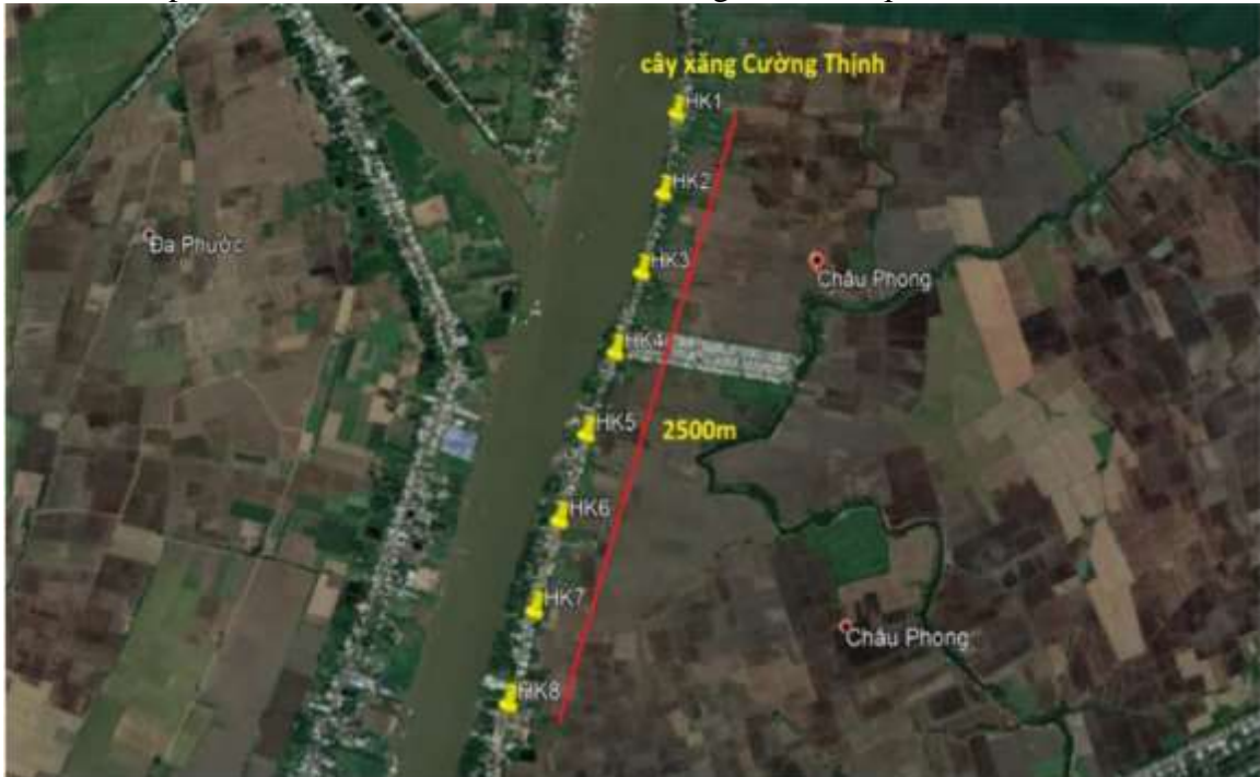
Hình 2.2: Sơ họa vị trí các hố khoan kè chống sạt lở bờ sông Hậu, xã Châu Phong huyện Tân Châu - An Giang
